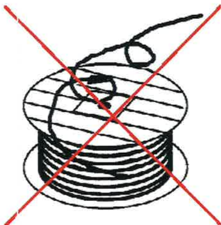
Rys. Błędny sposób odwijania przewodu z bębna (ustawienie na jednej flanszy)
