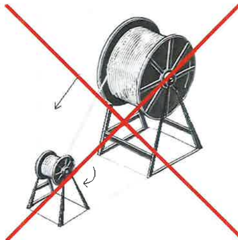
Rys. Błędny sposób przewijania przewodu z bębna na inny bęben
