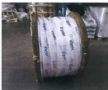
Zdj. Kabel zabezpieczony folią odporną na promienie UV
